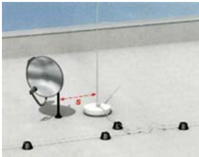
7 pav. Tinkamai išlaikytas atstumas tarp žaibo priėmiklio ir palydovinės antenos
