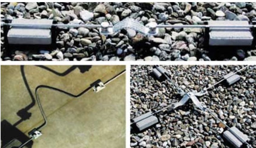
11 pav. Jungtys, kompensuojančios įtempimus laidinukuose dėl temperatūros pokyčių.
